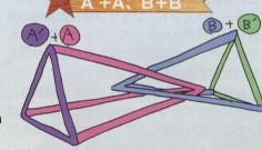
それぞれの3脚を横棒の三角形と結着。からみあっ た2つの三角すいにする。このとき、A´B´の横棒の 三角形の内側にAとBの脚を固定するようにする。また、 とくにAの方は脚の先が横棒から50cmほど飛び出すよ うにしておく(地面に埋め込ませるゆとり)。
