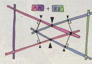
を、作業用の枕木に乗せ るなどして、A´のセン ターからBの頂点、Aの 頂点、B´のセンターが きれいに1本の線になる よう整えながら、AとB の脚の交点を結着する。 その後、ABの各頂点か ら互いの3本の脚へ、垂 直になるようにロープを 張る。これらのロープの 張りを調節しながら、セ ンターの1本線を保つよ うにする。
