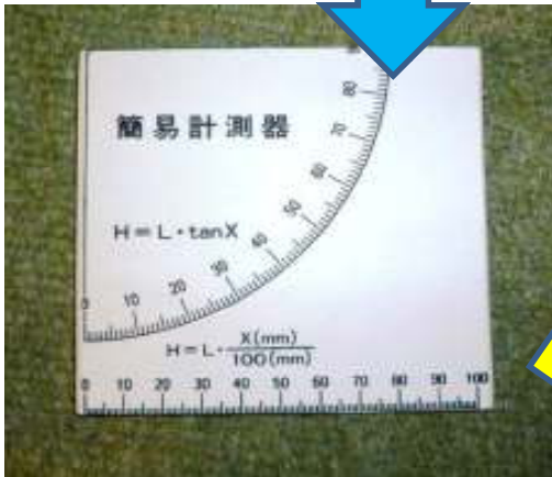
100×110mmの板 切り口を紙ヤスリで処理
